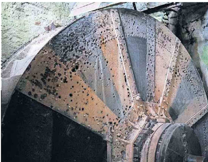
Das Wasserrad kam nach dem Wellbaumbruch in Schiefelage.
