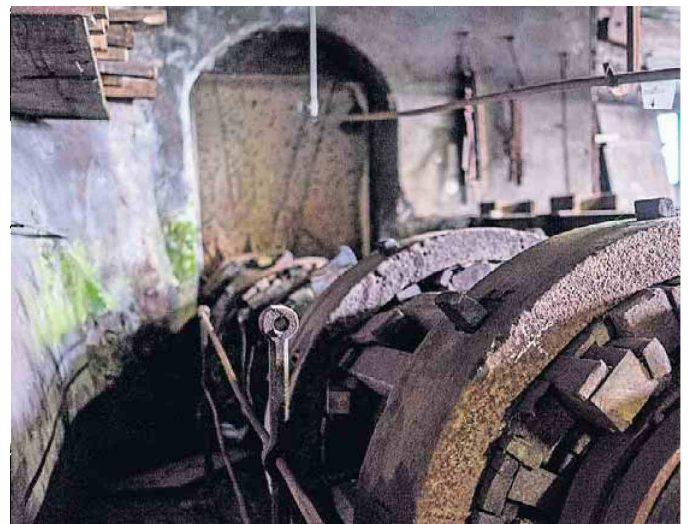
Der Wellbaum mit den Ringen und den sogenannten Fröschen.
